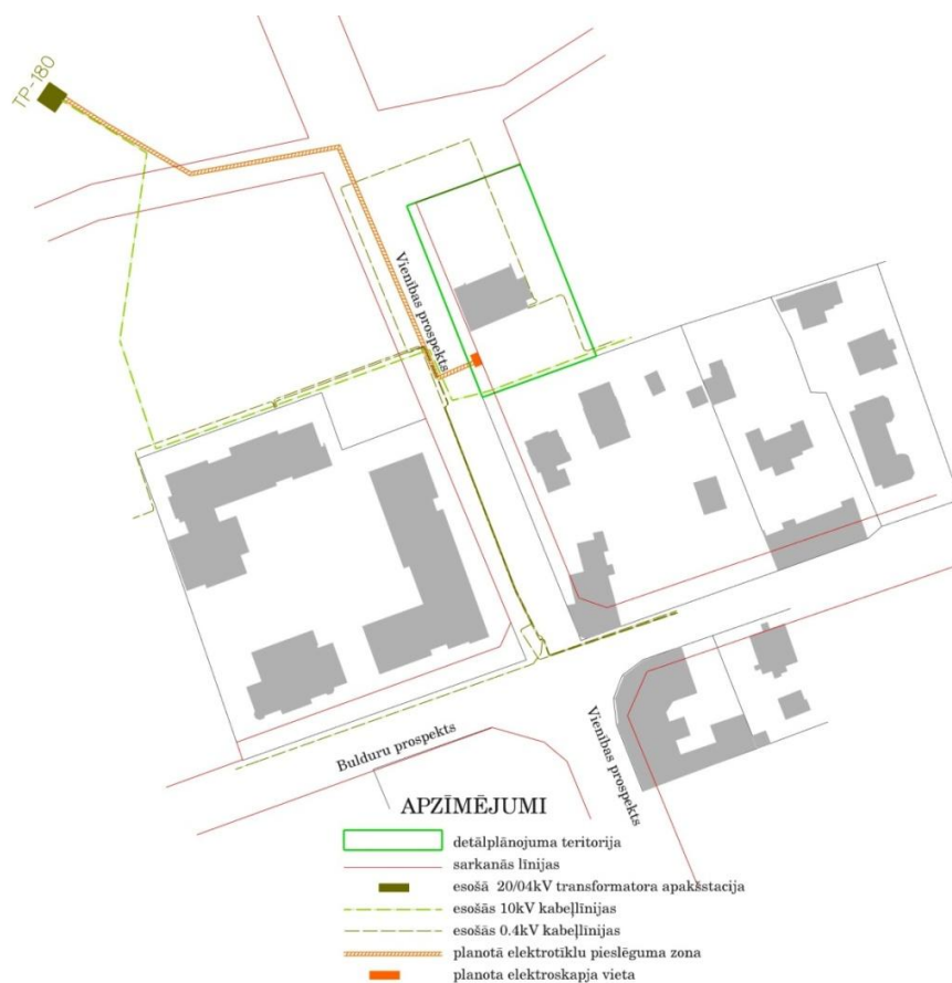
Elektroapgādes pieslēguma shēma. Shēma Nr.5.
