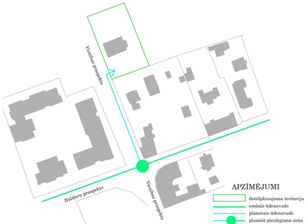
Detālplānojuma teritorijas notekūdeņu pieslēgums pilsētas tīkliem Shēma Nr.6.
