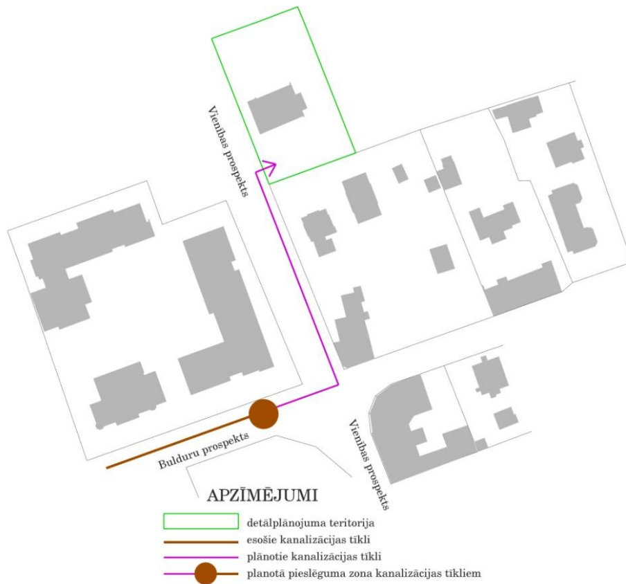
Detālplānojuma teritorijas notekūdeņu pieslēgums pilsētas tīkliem Shēma Nr.6.
