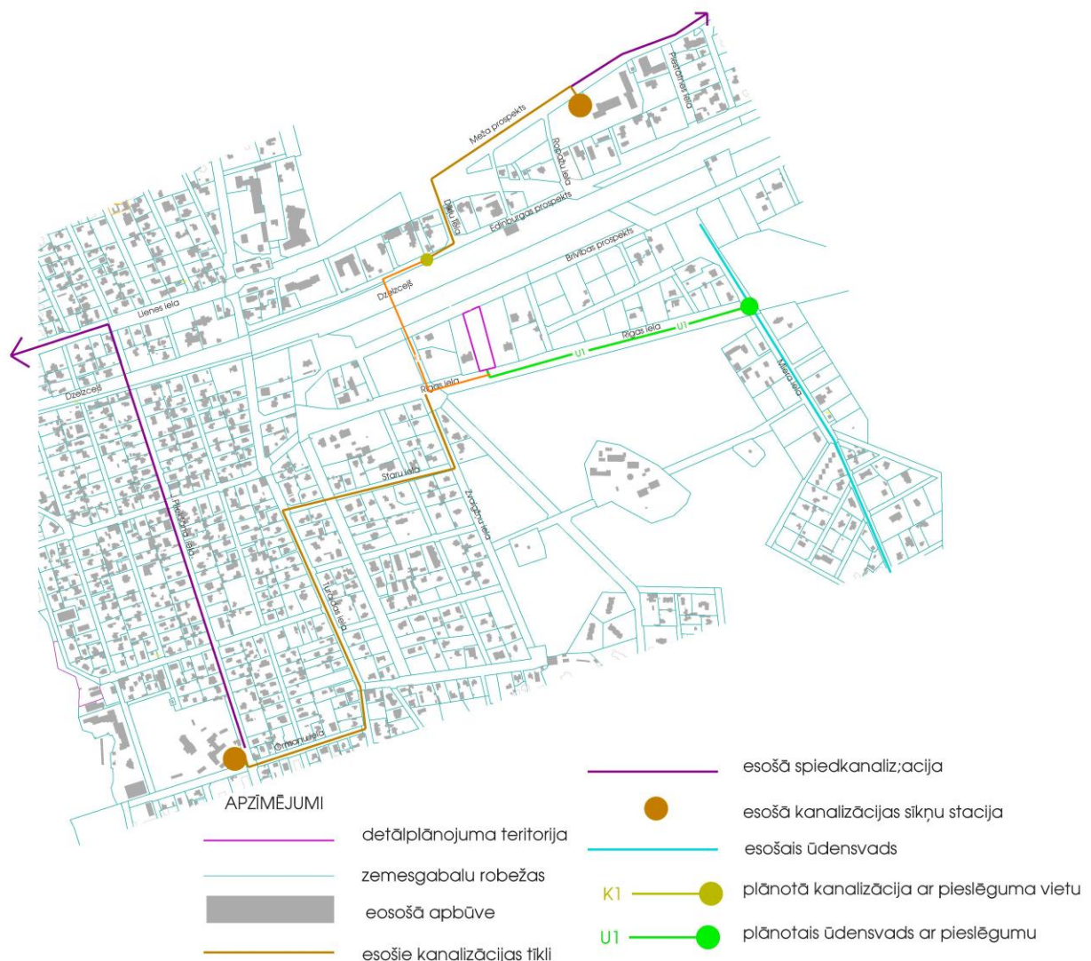
Ūdensapgādes un kanalizācijas shēma. Shēma Nr.5.
