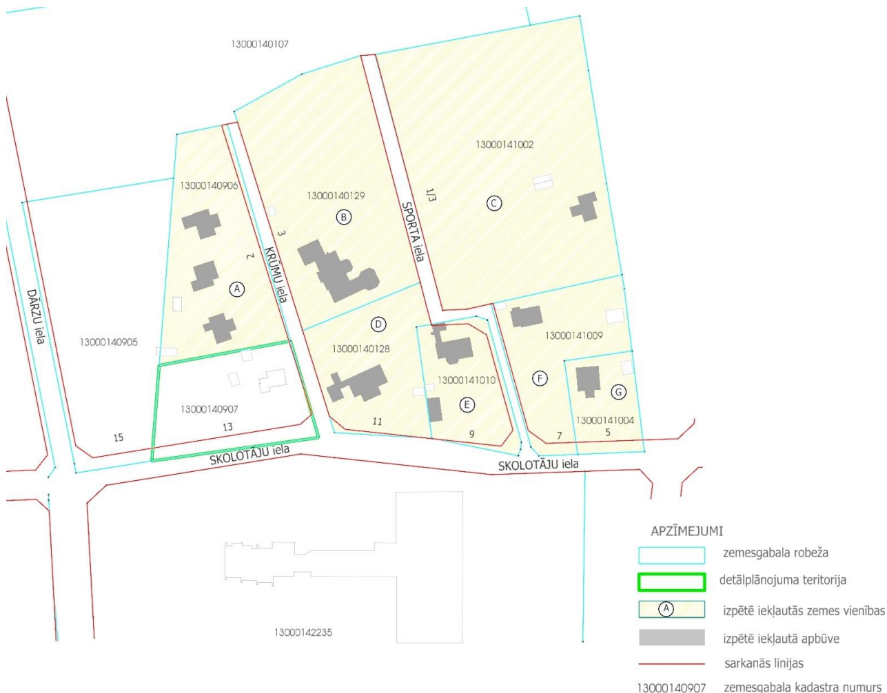
20.attēls. Būvapjomu analīzē iekļautās zemes vienības.
