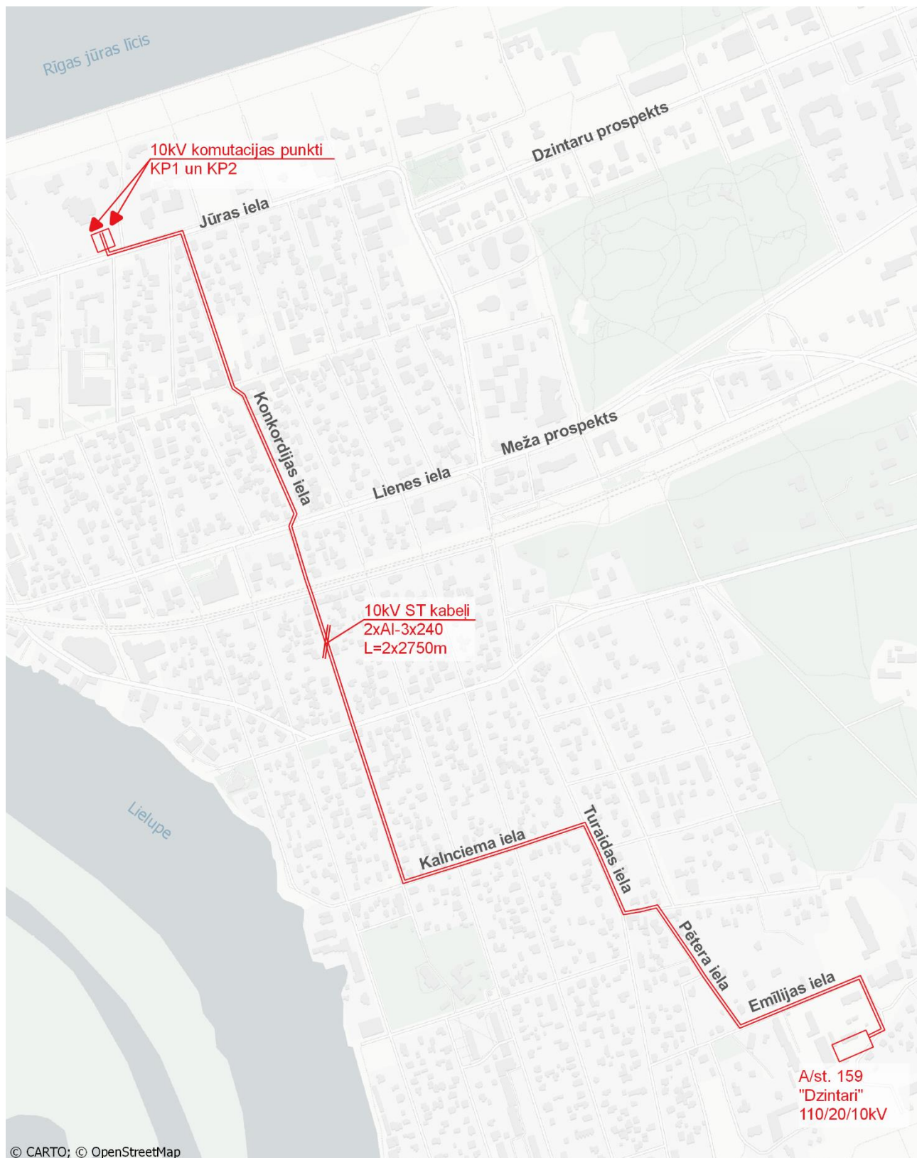
Attēls 31 Detālpārplānojuma teritorijas elektroapgādes tīklu nodrošinājuma shēma. Autors: SIA "A. Ābeles inženieru birojs"
