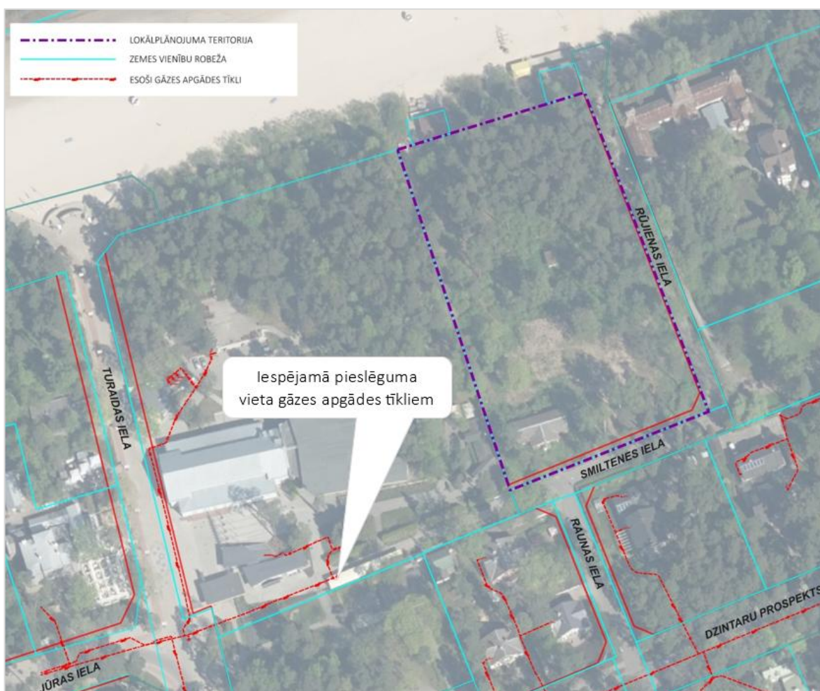
48. attēls. Esošo gāzes apgādes tīklu izvietojuma shēma.
